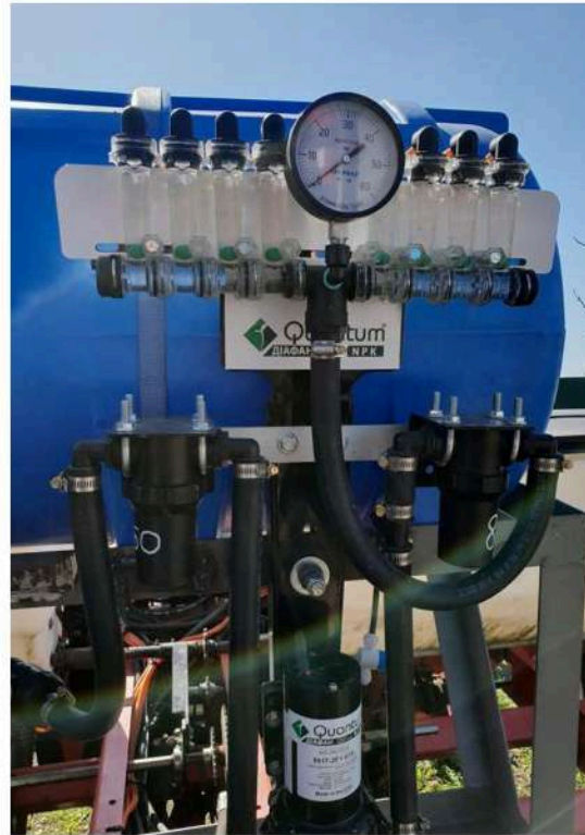
Система визуального контроля внесения удобрений Manifold с насосной системой
