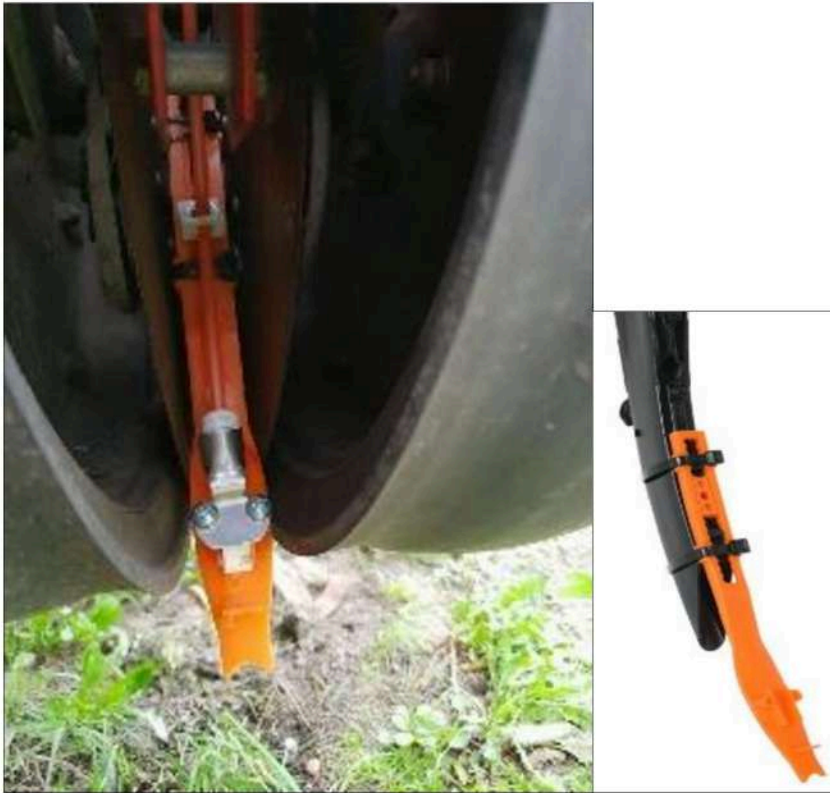
Устройство Rebounder Seed Cover для внесения жидких удобрений в борозду по технологии POP-UP
